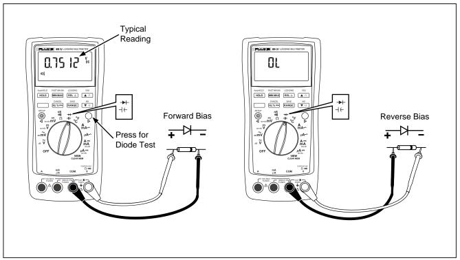
Figure 3-9. Diode Test
