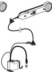
Figure 2b. Rastreamento de cabos
